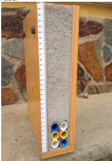
Ex. de secció de microrasa de 6c20mm amb reblert de mortor
