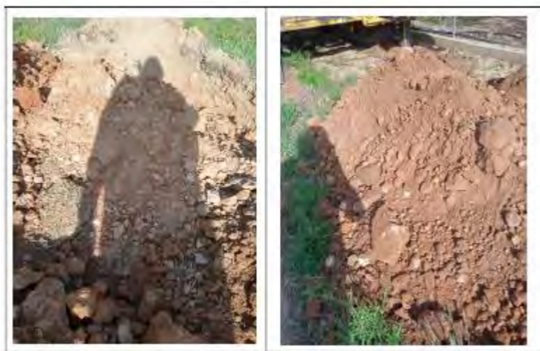
Figura 2.- Aspecte graves extretes de cales C-1 i C-2 respectivament
