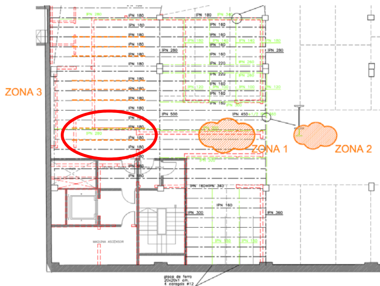
Imatge de la zona prevista a reforçar on no es van col·locar els perfils de reforç
